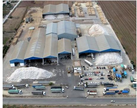
● Actualmente nuestra planta de desmotado, cuenta con dos líneas de desmotado marca consolidated, con una capacidad máxima de hasta un millón de kilos de algodón bruto, en una jornada completa de 24 horas.
